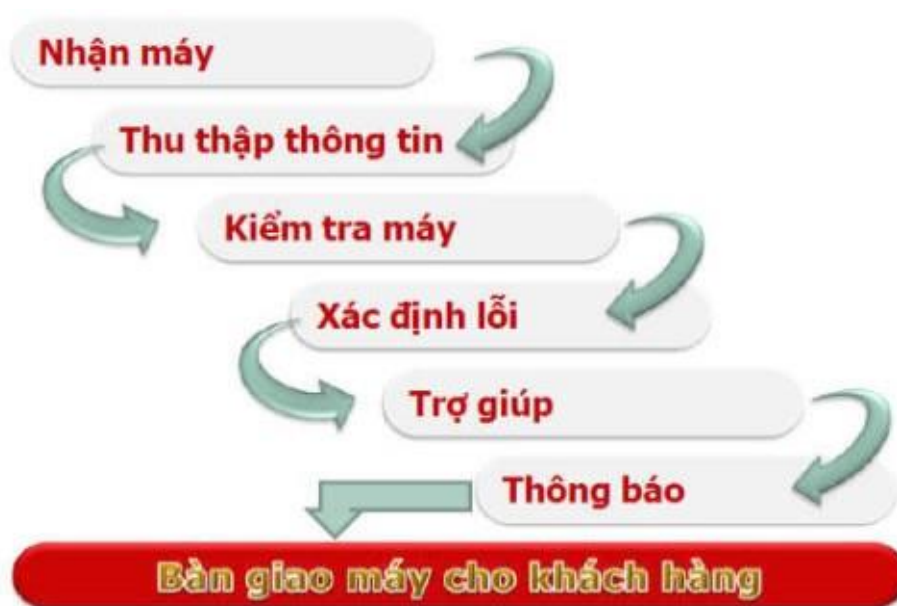
Hình 1.1. Mô hình xử lý sự cố máy tính
