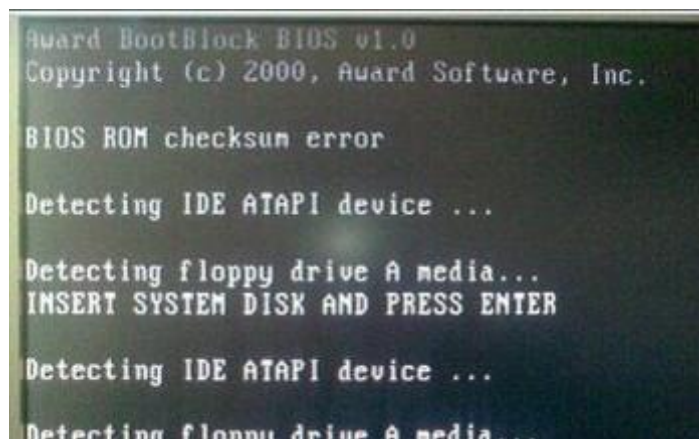
Hình 7.16. Lỗi khi nâng cấp BIOS
