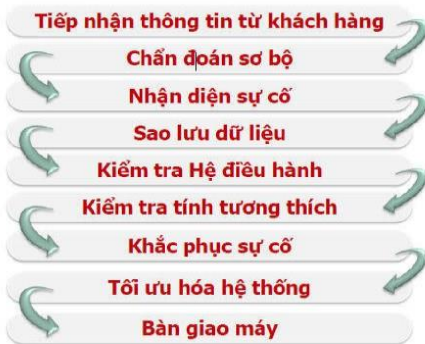
Hình 1.2. Quy trình xử lý sự cố phần mềm
