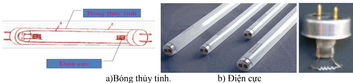
Hình 3.8: Cấu tạo bóng đèn huỳnh quang
