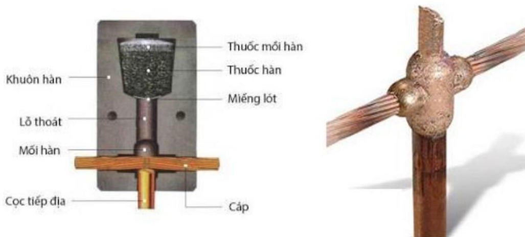
Hình 5.11: Hàn dây tiếp địa và cọc
