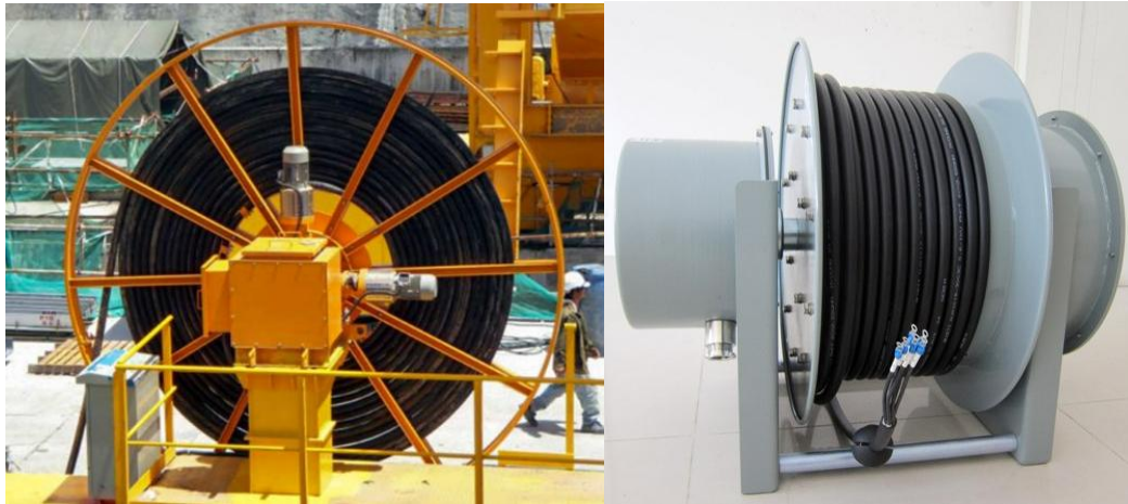
Hình 2.7. Đặt lô dây lên rulo để rải dây
