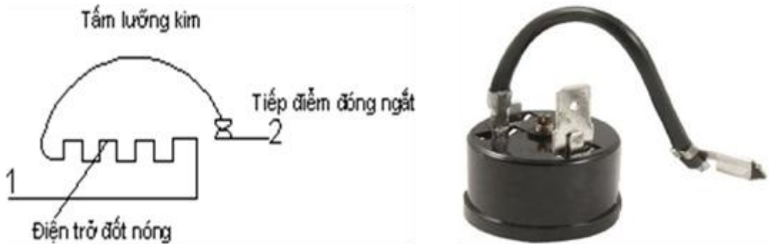
Hình 2.2. Thiết bị bảo vệ quá dòng máy nén kín
