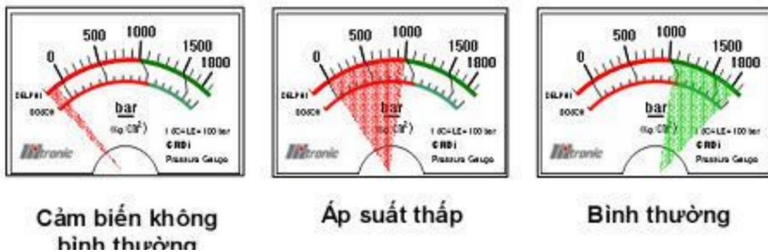
Hình 3.95 : Kiểm tra đường cao áp
