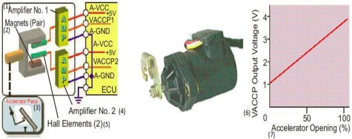
Hình 3.62: Cảm biến vị trí bàn đạp ga loại phần tử Hall
